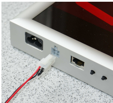
Rysunek 2: Podłączenie syreny do zegara
